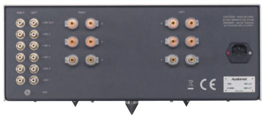
Bi-Wiring, einfach gemacht: Der Audiomat Solfege Reference 20 verfügt über doppelt angelegte Lautsprecherklemmen mit Vier- und Acht-Ohm-Anpassung. Seine Quellenumschaltung erfolgt konventionell via Stufenschalter und ohne die heutzutage üblichen, elektronisch angesteuerten Umschalt-Relais.
