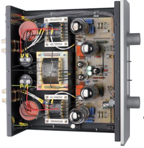
Die Kabelverlegung im Audiomat-Amp zeugt von penibler Lötkunst. Den beiden Netzteil-Kondensatoren (schwarz, hinter dem mittigen Netztrafo) wurden große Folien-Kapazitäten (rot) parallel geschaltet. Links und rechts neben dem Netztrafo sitzen die beiden Ausgangsübertrager.
